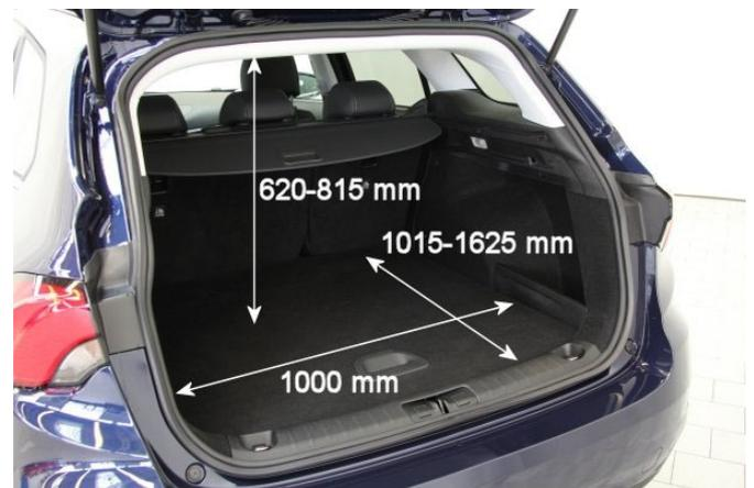
Mit 470 l Volumen ist der Kofferraum des Tipo einer der größten seiner Fahrzeugklasse.
